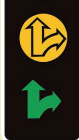
S 3b Signál s kombinovanou směrovou šipkou se žlutým světlem „Pozor!“
